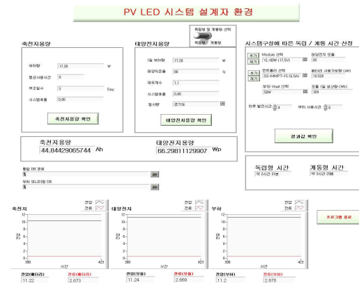
[그림 4] LED 부하용 태양광발전시스템 설계 소프트웨어의 사용자 인터페이스
