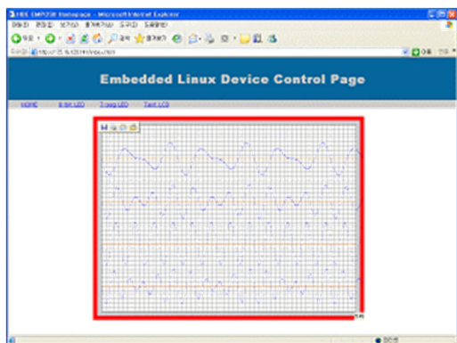
[그림 21] 여러 채널의 센서 모듈 모니터링에 대한 사용자 PC에서 접속한 화면
