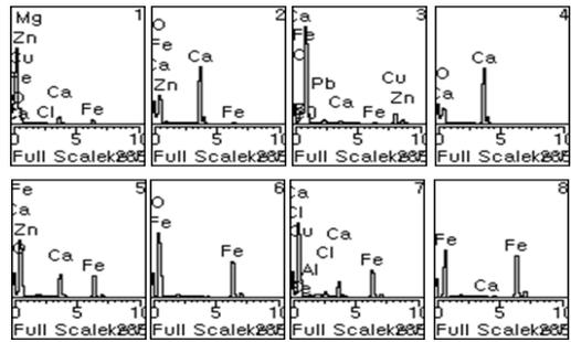
[그림 8] SWRO+Ca(OH)<sub>2</sub>+CO<sub>2</sub> 조건에서 탄소강과 내부 스케일에 대한 EDX 분석결과.
