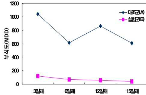
[그림 12] SWRO와  $\text{SWRO}+\text{Ca}(\text{OH})_2+\text{CO}_2$ +부식억제제에서의 조건에서 탄소강관의 부식도(MDD).
