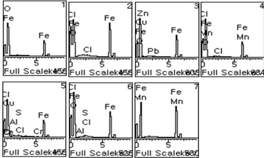
[그림 5] SWRO 생산수에서의 탄소강 EDX 측정치.
