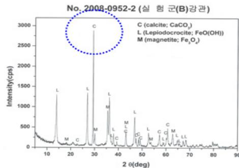
[그림 9] SWRO+Ca(OH)<sub>2</sub>+CO<sub>2</sub> 조건에서 탄소강관 내부 스케일에 대한 XRD 결과.
