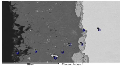
[그림 7] SWRO+Ca(OH)<sub>2</sub>+CO<sub>2</sub> 조건에서 탄소 강관 측면의 SEM 분석결과
