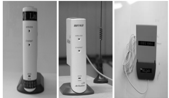
[그림 5] WLAN 무선통신 장비 [Fig. 5] Access Point, Ethernet Converter, and Diversity Reception Antenna
