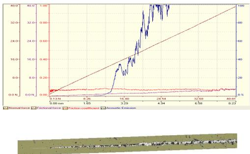
[그림 9] Scratch test법을 이용한 접착력 측정
