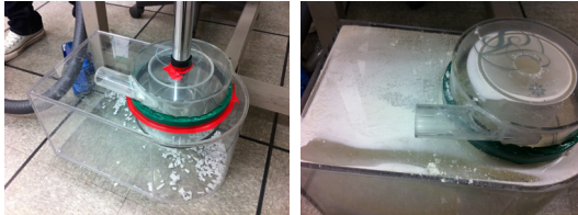
[그림 11] 분진여과시험: 좌(종이), 우(밀가루) [Fig. 11] Dust Filtering Test: Left(Paper), Right(Wheat Flour)
