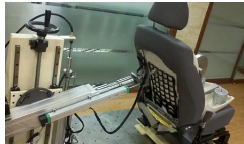
[그림 7] 서스펜션에서의 변형량 측정 실험 [Fig. 7] Experiment of displacement measurement at suspension
