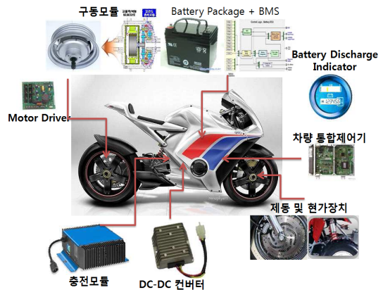
[그림 1] 전기이륜차 부품 구성 [Fig. 1] Components of electric motorcycle
