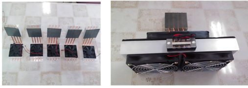
(a) Heat pipe (b) Heat pipe+펠티어 조합형 [그림 6] Heat pipe(100 W+5=500 W)와 펠티어 (100 W) + Heat pipe(100 W) 조합형 사진 [Fig. 6] Photo of combined Heat pipe(100 W+5=500 W) and peltier(100W)+heat pipe(100W)
