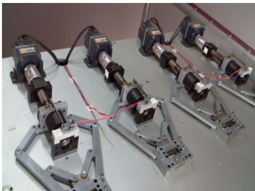
[그림 4] 압축-절단 장치 [Fig. 4] Compressing-cutting device
