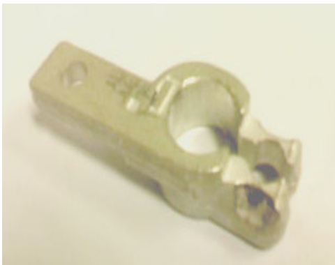
[그림 2] 배터리 포스트 클램프의 몸체 [Fig. 2] Body of battery post clamp
