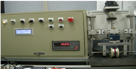
[그림 8] 자석바퀴 자력 측정 장치 [Fig. 8] Test equipment of PM wheel
