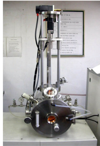
[그림 1] Czochralski 결정 육성 시스템
