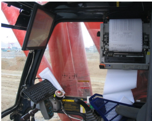
[그림 10] 측정장비가 설치된 시공장비의 운전석
