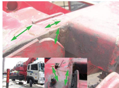
[그림 1] 응력집중으로 인한 크랙 발생
