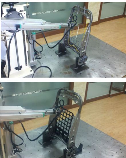
[그림 6] 서스펜션의 변형량 측정 실험
