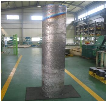
[그림 1] Double Melted Gr2 Ingot (직경400mm, 1000kg)
