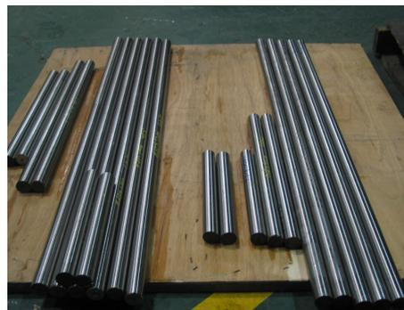
[그림 4] 직경 42mm선재(Round Bar)
