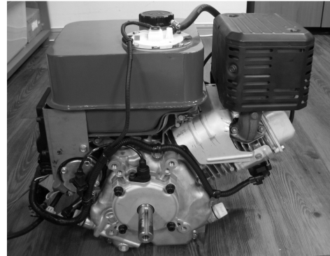
[그림 2] EFI 방식 엔진 시제품
