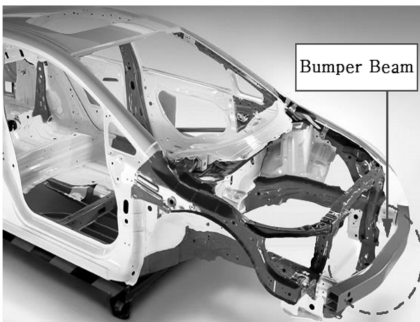
[그림 1] 범퍼 빔의 형상 및 장착위치
