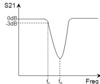
[그림 5] DGS 전송선로의 일반적인 전달특성 곡선
