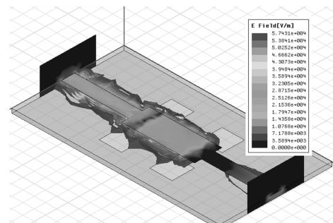
[그림 10] DGS를 이용하여 설계한 3단 LPF의 E-field의 분포
