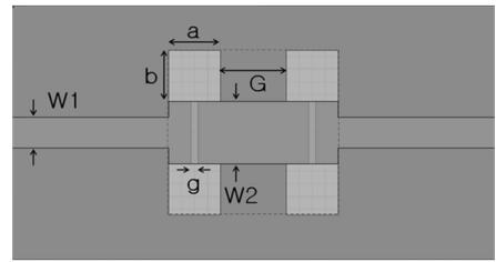
[그림 8] DGS를 이용하여 설계한 3단 LPF의 설계 레이아웃
