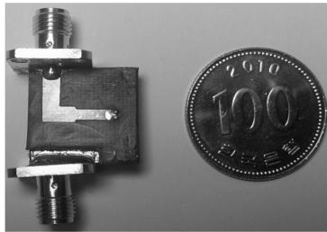
[그림 14] CDGS를 이용하여 제작한 3단 LPF의 사진
