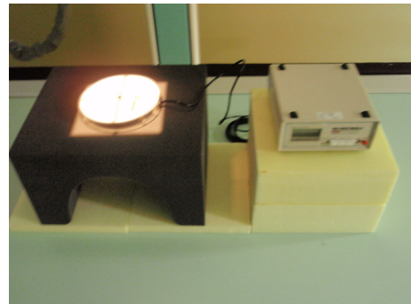
[그림 1] 입사표면선량 측정 [Fig.1] Measurement of ESD
