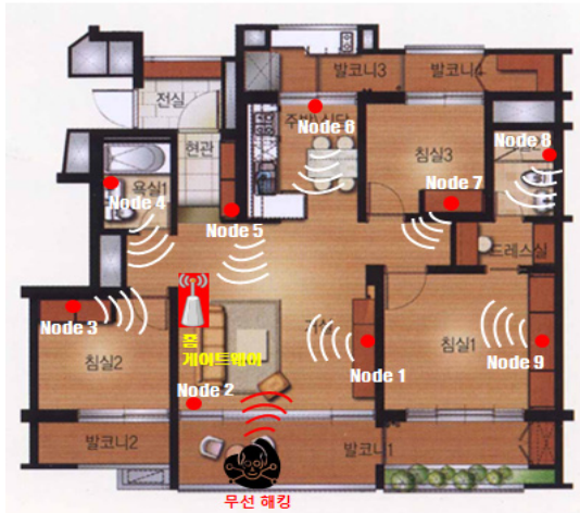
[그림 8] 스마트 홈에 실험을 위해 센서노드 배치 [Fig. 8] Smart home for experiments placed the sensor nodes
