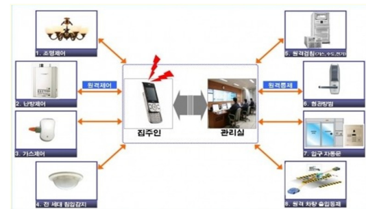
[그림 2] 스마트 홈 구성도 [Fig. 2] smart home configuration
