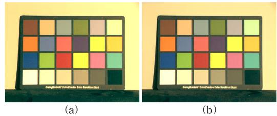
[그림 5] 그림 4 영상들의 canonical 일루미넨트하로 변환: (a) 그림 4의 (a) 영상의 변환, (b) 그림 4의 (b) 영상의 변환
