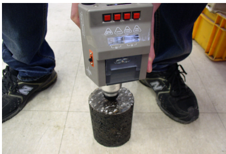
[그림 4] 상부표층의 반발경도측정 [Fig. 4] Hardness Test of HMA
