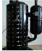
[그림 7] VI 픽업 부착모습 [Fig. 7] VI pick-up attached to a rotary comp.
