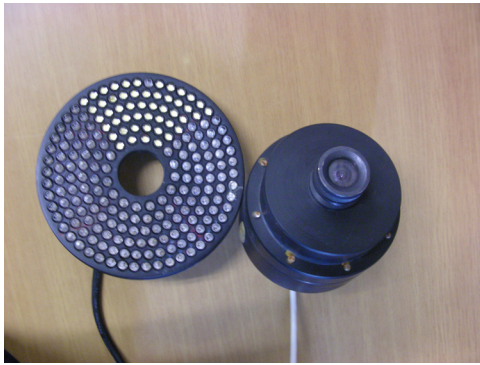
[그림 1] a) 적외선과 LED광원 디스크와 수중카메라, b) 테트라포드 [Fig. 1] a) Disk with infrared radiation & LED light, and underwater camera, b) target tetrapod
