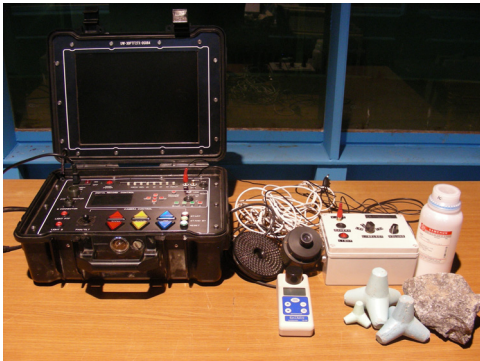
[그림 2] a) 이미지 영상장치와 데이터 저장장치, b) 탁도 측정기 [Fig. 2] a) Image displaying and data storage system, b) turbidity meter
