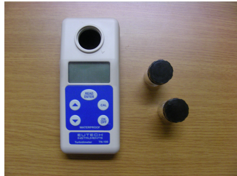
[그림 2] a) 이미지 영상장치와 데이터 저장장치, b) 탁도 측정기 [Fig. 2] a) Image displaying and data storage system, b) turbidity meter
