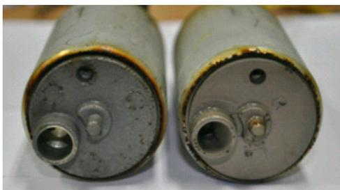
[그림 12] 250시간 부식 실험 후 연료 펌프 (좌 : 단조, 우 : 다이캐스팅)
