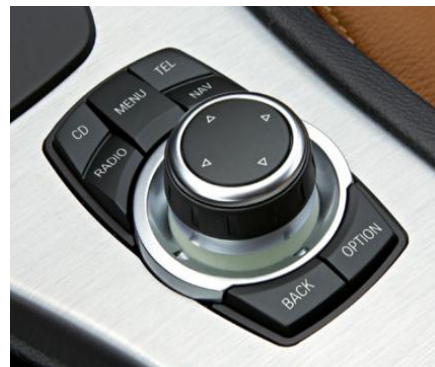
[그림 3] BMW사의 차량용 햅틱 디바이스 I-Drive [Fig. 3] BMW's vehicle haptic device I-drive
