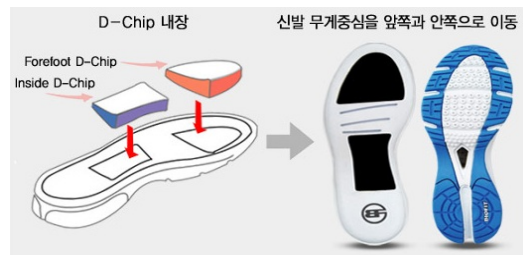
[그림 3] B사의 워킹화 신발 원리 [Fig. 3] Walking shoes principle of a B company
