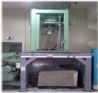
[그림 10] 굴진시험평가 장비 [Fig. 10] Machine for Penetration Test
