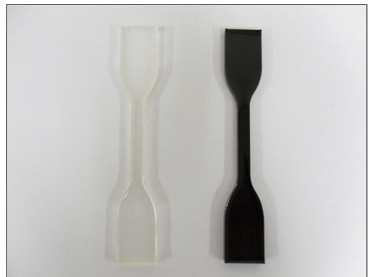
[그림 3] 에폭시만으로 만든 경우와 탄소나노튜브 강화된 도그본 형태의 시편 [Fig. 3] Dog-bone shaped specimens for a pure epoxy and a MWNTs-reinforced
