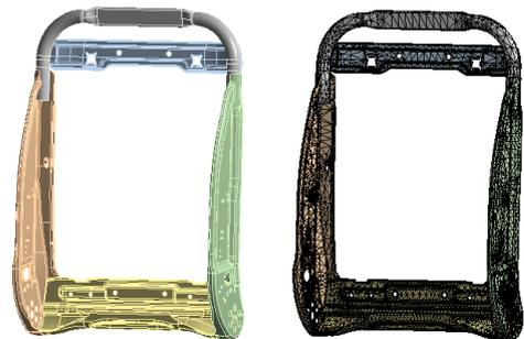
[그림 3] 시트 백 프레임의 모델 형상과 메시 형상
