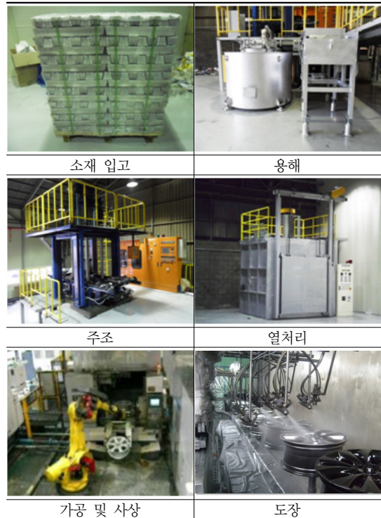
[그림 4] 마그네슘 휠 제조 공정 [Fig. 4] Manufacturing process of Mg wheel
