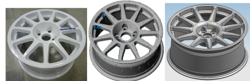
[그림 5] 해외 시판 마그네슘 휠 벤치마크 휠 역설계 [Fig. 5] The benchmark of Mg wheel reverse engineering in the overseas market
