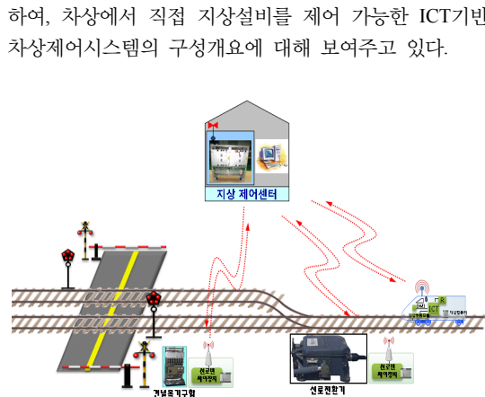
[그림 2] 제안하는 ICT기반 차상중심 열차제어시스템의 구성
