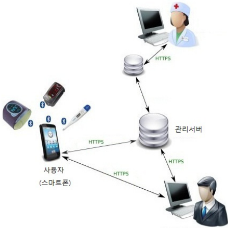
[그림 7] 관리서버 와 인증 노드의 관계 [Fig. 7] Relationship between Management Server and Authentication Nodes
