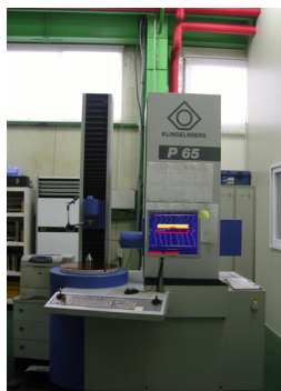
[그림 5] 기어측정기(Klingelnberg사 P65) [Fig. 5] Gear tester(Klingelnberg사 P65)
