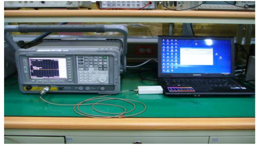
[그림 5] 2.4GHz Zigbee의 부차적 전파발사 측정
