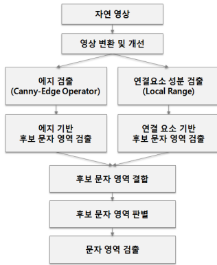
[그림 1] 문자영역 검출 절차 [Fig. 1] Character Region Detection Procedure
