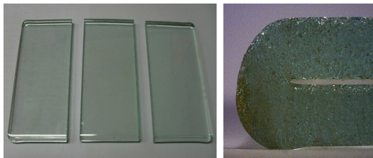
[그림 7] 유리 절단 및 단면형상 [Fig. 7] Cutting and cross sectional shape of glass
