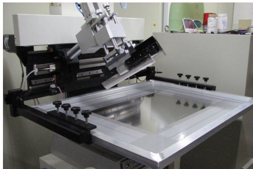
[그림 1] Pillar 배치를 위한 스크린 인쇄 장치 [Fig. 1] Screen printing system for pillar arrangements
