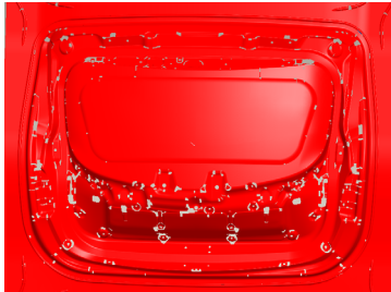
[그림 3] 읍셋곡면 생성 전의 갭 발생상태 [Fig. 3] A directly reconstructed surface having gaps and holes without surface offsetting process
