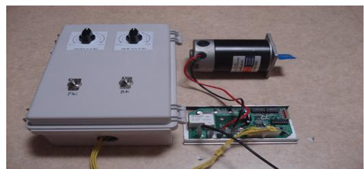
[그림 13] 개발된 DC모터 콘트롤러의 전후진 속도 테스트
