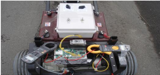
[그림 14] 개발된 DC모터 컨트롤러의 전동차 구동테스트
