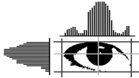
[그림 6] 히스토그램을 이용한 눈동자 중심점 검출 [Fig. 6] The pupil center detection using the histogram
