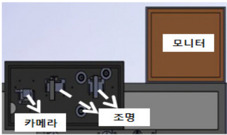
[그림 8] 검사부의 개략도 [Fig. 8] Schematic diagram of testing part
