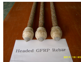
[그림 4] 정착판 GFRP근 보강재 [Fig. 4] Headed GFRP rebar
