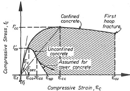
[그림 6] 콘크리트의 응력 변형률 관계(Mander, 1988)
