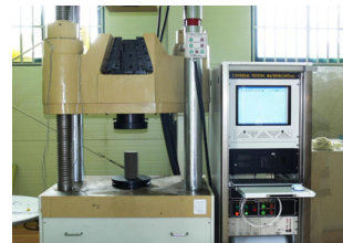
[그림 4] 시험에 사용된 만능시험기(UTM)
