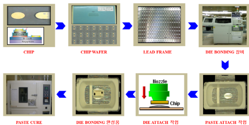
[그림 1] 다이 본딩 공정 [Fig. 1] Die bonding process
