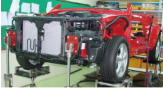
[그림 3] 개발된 실차 시뮬레이터 [Fig. 3] The developed Real Car Simulator
