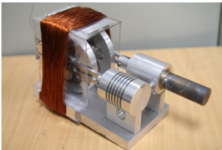
[그림 4] 스텔링 엔진에 발전기를 부착한 모습 [Fig. 4] A generator attached at the engine
