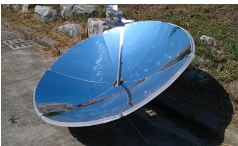
[그림 6] 소형 태양열 발전기를 이용하여 on-sun test를 수행하는 모습 [Fig. 6] On-sun test conducted using a small-sized solar power generation system
